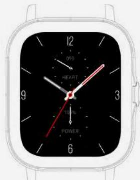
Depuis l'interface de l'écran de la montre, appuyez sur le bouton pour entrer ou sortir du menu. Une fois dans l'interface d'une fonction, appuyez sur le bouton pour revenir à l'interface de l'écran. Appuyez et laissez enfoncé le bouton pour éteindre ou allumer la montre intelligente.
