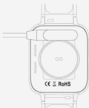
**⚠️** Tenere in considerazione che le due spine del cavo USB non devono entrare in contatto con il conduttore simultaneamente, oppure si potrebbero verificare corto circuito o bruciature.
