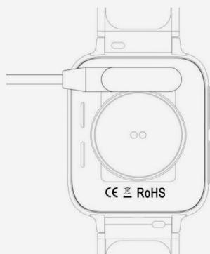
**⚠️** Asegúrese de que las dos clavijas del cable USB no entren en contacto con el conductor al mismo tiempo, ya que podría ocurrir un cortocircuito y quemarse.
