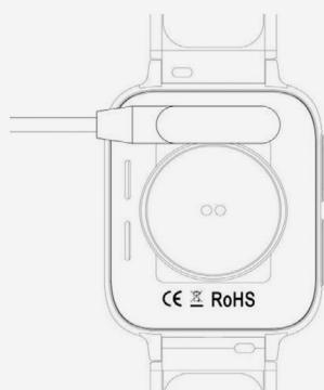
**⚠** Achten Sie darauf, dass keine zwei Pins des USB-Kabels den Leiter gleichzeitig berühren dürfen, dies kann zu einem Kurzschluss und zu einem Brand führen.
